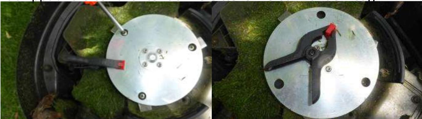
Wer keine Mini Klammer hat, kann auch eine Schraube soweit rausdrehen, dass sie im Loch den Teller blockiert
