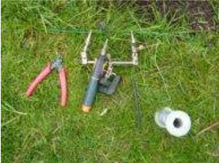
GaslötKolben & Helping Hand. Draht zusammensetzen, reparieren ohne Klemmen mit Löten, bisschen Vaseline auf Lötstelle, dann zweimal Klebe-Schrumpfschlauch drüber, Ameisenresistent, hält ewig
