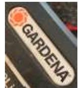
ich kann es immer noch nicht glauben, dass man das Logo entfernen (mit Gefahr der Zerstörung) MUSS um an diese beiden Schrauben ranzukommen. Vor allem weil das ist ja absehbar, dass früher oder später sich die oberen lösen statt die unteren, vor allem wenn a) die oben nicht gesichert sind und b) die unten sich festrosten. das passiert ja auch im Service und dann müssen die auch das Logo entfernen/zerstören.
